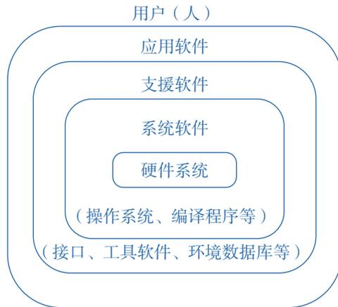
图 1-8 计算机系统层次结构
